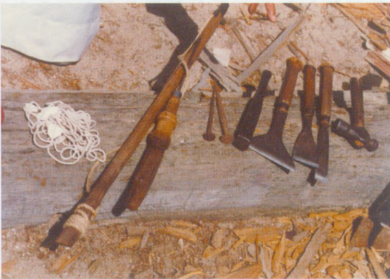
بعض أدوات العمل في صناعة السفن: الفأس، المطرقة، المنشار، المسامير والمجدح.
